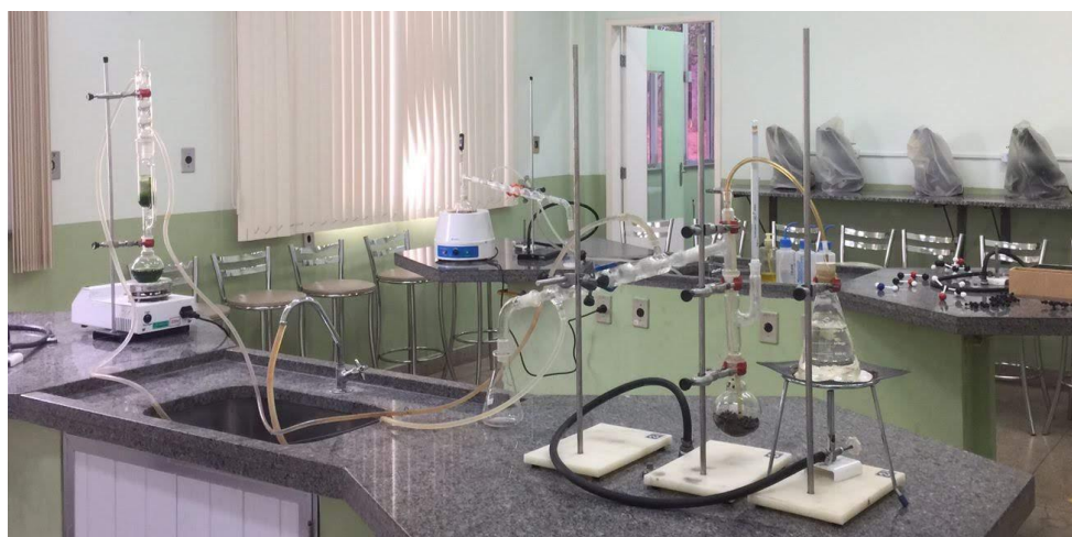
Figura 04. Montagem das vidrarias para extração.
